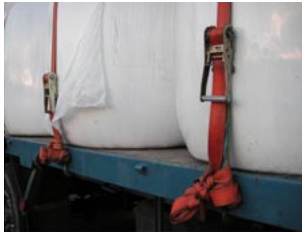
Die Ladungssicherung schwerer Güter umfasst oft eine Kombination von Form- und Kraftschluss. Zum Beispiel werden Silageballen teils gegen die vordere Ladewand abgestützt (formschlüssig) und zusätzlich mit Zurrgurten in Längs- und Querrichtung niedergezurrt (kraftschlüssig).
